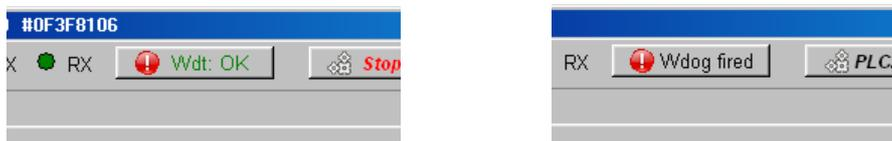
Il pulsante "Wdt: OK" / "Wdog fired" serve per controllare lo stato del watch-dog e impostarne il funzionamento. Esso consente tre operazioni:
